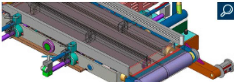
Le système Quick-Change-Over est un guidage latéral situé juste en amont de la lame. Ce système motorisé s'adapte automatiquement aux largeurs des produits. Il est particulièrement avantageux en cas de produits de différentes largeurs ou si vous tranchez une large gamme de produits. Vous améliorez la qualité de coupe et diminuez le temps de changement de produit.
