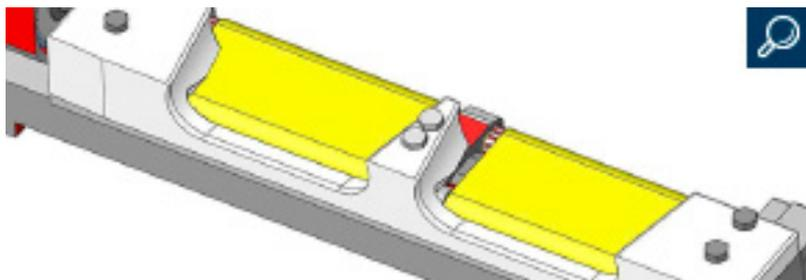
Le bord de coupe motorisé supporte le produit activement et ce au niveau de sa coupe. Ce guidage synchronisé contrôle le déplacement du produit et améliore nettement sa coupe, surtout pour des produits élastiques.
