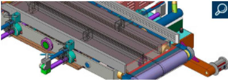
Das Ausstattungsmerkmal Quick-Change-Over ist eine seitliche Führung direkt vor dem Messer. Es ist motorgetrieben und passt sich unterschiedlichem Produktbreiten automatisch an – besonders vorteilhaft bei unterschiedlich breiten Produkten. So wird die Schnittqualität automatisch erhöht, gerade wenn Sie Ihre Produkte oft wechseln oder variieren.
